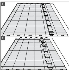
Incline la fila de baldosas serradas hacia la fila correspondiente, incluidas las piezas de las esquinas.
