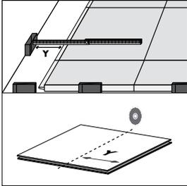
Para terminar toda la fila, las piezas de las esquinas deben medirse y serrarse en la parte superior e inferior. Para serrar la parte inferior de la pieza de la esquina, mida la distancia entre la cuña y toda la fila a lo ancho y sierre la baldosa para que encaje en la distancia medida.
