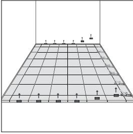
Presione todas las piezas entre sí utilizando la palanqueta. Retire todas las cuñas separadoras.
