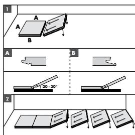
Coloque la primera baldosa en la esquina izquierda de la habitación (a unos 15 cm de la pared) con los dos lados con lengüeta orientados hacia la pared. Coloque toda la fila inclinando y ensamblando tantas baldosas sin serrar como sea posible.
