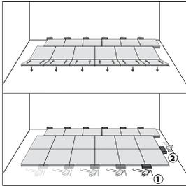
Ahora incline toda la nueva fila de baldosas hacia la fila que ya está colocada. Ensamble las baldosas mediante pequeños golpes usando para ello el taco de impacto (véase imagen 1). Asegúrese de que todas las juntas de todas las baldosas encajan entre sí perfectamente.
