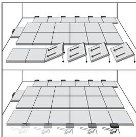
Repita la operación para la fila siguiente. Ensamble las baldosas sin serrar entre sí para colocar una nueva fila y haga todo lo posible para alinear las baldosas al colocarlas. De nuevo, las pequeñas diferencias se pueden corregir con el taco de impacto.
