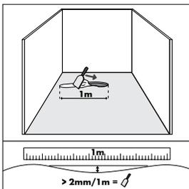
Asegúrese de que la base del suelo esté plana. Elimine cualquier desnivel superior a 2 mm (1/16") en una longitud de 1 metro (40").
