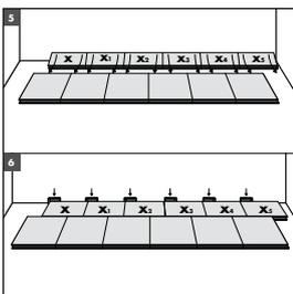
Incline toda la fila hacia la fila que ya está colocada. Para asegurarse de que la primera fila completa de baldosas permanece en línea mientras se coloca el resto del suelo, asegúrese de que las baldosas X se encuentren como mínimo a 10 cm (0,32 pies) de las baldosas ya colocadas. No se olvide de colocar las cuñas entre las baldosas X y el tabique para dejar una junta de dilatación.
