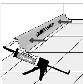
Instale los rodapiés sobre la membrana plástica que se proyecta verticalmente desde el suelo sobre el tabique. No sujete nunca los rodapiés al suelo. Este método permite que el suelo se expanda y se contraiga bajo los rodapiés. En los lugares donde no se pueden utilizar perfiles o rodapiés, es necesario rellenar las juntas de dilatación con pasta elástica (Quick • Step® Kit).
