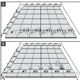
Incline y ensamble todas las piezas x' serradas entre sí. Intente colocar las baldosas serradas para que formen una línea al ensamblarlas entre sí. Las pequeñas diferencias se pueden corregir con el taco de impacto. Esta fila de baldosas serradas debe moverse entre la pared y la última fila.
