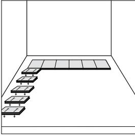
Obtendrá el efecto más atractivo colocando el suelo simétricamente respecto a la estancia. Para hacerlo, las baldosas de las filas exteriores deben tener el mismo ancho a lo largo y a lo ancho de la estancia.
