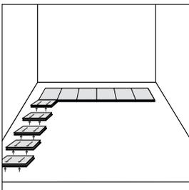
Ya ha calculado dónde debe ir colocada la primera fila para que el suelo se instale perfectamente simétrico en la habitación y puede quitar las baldosas colocadas a lo ancho. Si fuera necesario, realice una marca en la capa base para indicar la posición de estas baldosas.
