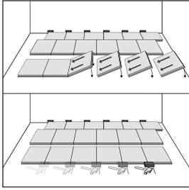
Utilice el mismo método para la siguiente fila. Ensamble las planchas sin serrar entre sí para colocar una nueva fila y haga todo lo posible para alinear las baldosas al colocarlas. Las pequeñas diferencias se pueden corregir con el taco de impacto.
