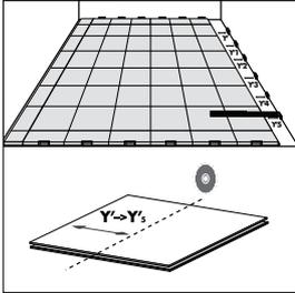
El último paso consiste en terminar el lado derecho. Para serrar la parte inferior de la pieza de la esquina, mida la distancia entre la pared derecha y el suelo ya colocado. No olvide dejar una junta de dilatación.
