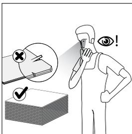
Inspeccione todas las planchas bajo una luz suficiente antes y durante la instalación. No utilice nunca planchas con defectos visibles.
