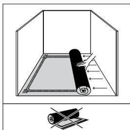
Es necesario retirar antes cualquier revestimiento del suelo no estanco (moqueta, fieltro agujereado, etc.) existente. No hay necesidad de retirar los revestimientos de suelos estancos (PVC, linóleo, etc.). Utilice siempre un subsuelo, preferentemente un subsuelo Quick • Step®.
