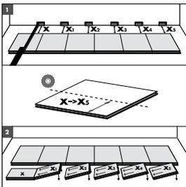
En el paso siguiente, debe colocar las baldosas serradas entre la pared y la primera fila. Coloque cuñas de separación para dejar una junta de dilatación de 8 a 10 mm (5/16" a 3/8").
