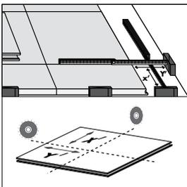
Entonces, mida la distancia  $X'$  según se indica en la figura y sierre la pieza de la esquina por la parte inferior...
