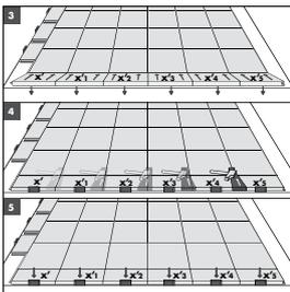
Incline la fila de piezas serradas hacia la fila anterior. No se olvide de colocar las cuñas entre las baldosas X y el tabique para dejar una junta de dilatación. Utilice la palanqueta para cerrar las juntas de la última fila de baldosas serradas.
