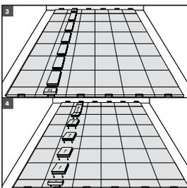
Una vez medidas y serradas las dos piezas de las esquinas, puede inclinar toda la fila de baldosas serradas (incluidas las piezas de las esquinas). Asegúrese de que estas baldosas serradas estén perfectamente alineadas.
