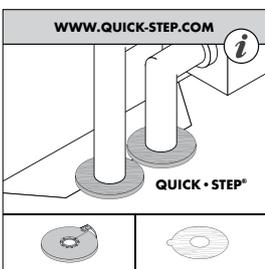
Para un acabado perfecto en torno a las tuberías, utilice las rosetas de Quick • Step® o pasta elástica (Quick • Step® Kit).
