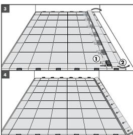
Ajuste las juntas con el taco de impacto e incline la fila para que encaje en su posición correcta.
