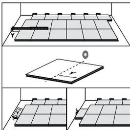
Una vez colocada la segunda fila, mida y sierre la pieza Y entre la pared lateral y las dos filas ya colocadas. No se olvide de colocar las cuñas entre las baldosas Y y el tabique para dejar una junta de dilatación. Ensamble la pieza final Y serrada con una hendidura de 10 cm (0,32 pies) al principio de las dos filas terminadas.
