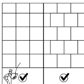
Las baldosas se pueden colocar con juntas continuas (no al trefado) o al trefado. Colocar las baldosas con juntas continuas requiere más atención. Por este motivo, este es el método que se explica en más detalle aquí.
