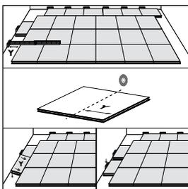
Una vez colocada la tercera fila, mida y sierre la pieza Y entre la pared lateral y las filas segunda y tercera ya colocadas. De nuevo, no se olvide de colocar las cuñas entre las baldosas Y y el tabique para dejar una junta de dilatación. Ensamble la pieza final Y serrada, con una hendidura de 10 cm (0,32 pies), al principio de las filas segunda y tercera.
