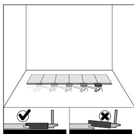
Intente colocar las baldosas para que formen una línea al ensamblarlas entre sí. Las pequeñas diferencias se pueden corregir con el taco de impacto. Coloque el taco de impacto en la junta entre las dos baldosas y, con un martillo, golpee suavemente el taco de impacto. Asegúrese de colocar el taco de impacto tal y como se indica en el diagrama para evitar causar daños.
