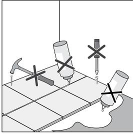
Uniclic® es un sistema revolucionario para la instalación de suelos laminados flotantes sin necesidad de utilizar cola. Los paneles encajan perfectamente entre sí gracias a la ingeniosa forma de la lengüeta y de la ranura.
