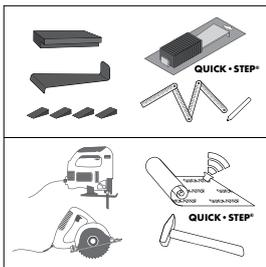
Además de las herramientas convencionales (como un martillo, una sierra, un lápiz y una cinta de medir) para la colocación de suelos de madera, precisará los accesorios siguientes: kit de instalación (palanqueta, cuñas y el taco de impacto específico para Uniclic®) capa base productos de limpieza
