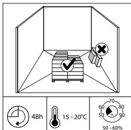
Deje que las planchas se aclimaten durante 48 horas en el embalaje original cerrado, a temperatura ambiente y en el centro de la habitación donde se va a colocar el suelo. Las condiciones ideales de instalación son las siguientes: una temperatura comprendida entre 15° y 20 °C (59-68 °F), una humedad relativa del aire situada entre el 50 % y el 60 %.
