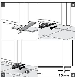
Cuando sierre los paneles, asegúrese de que la junta de dilatación debajo de la puerta sea como mínimo de 10 mm (3/8"). Si no puede elevar el panel, utilice un taco de impacto adecuado o una palanqueta y un martillo para ensamblar los paneles entre sí.
